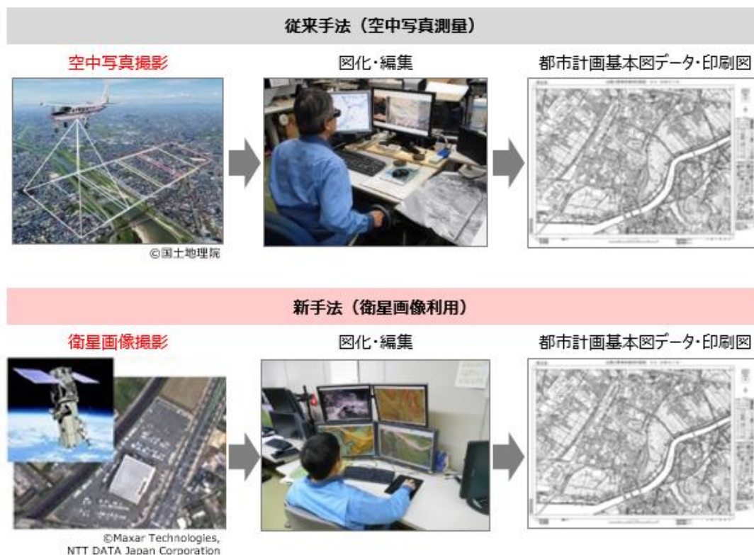
図1 衛星画像データを利用した新しい測量技術
